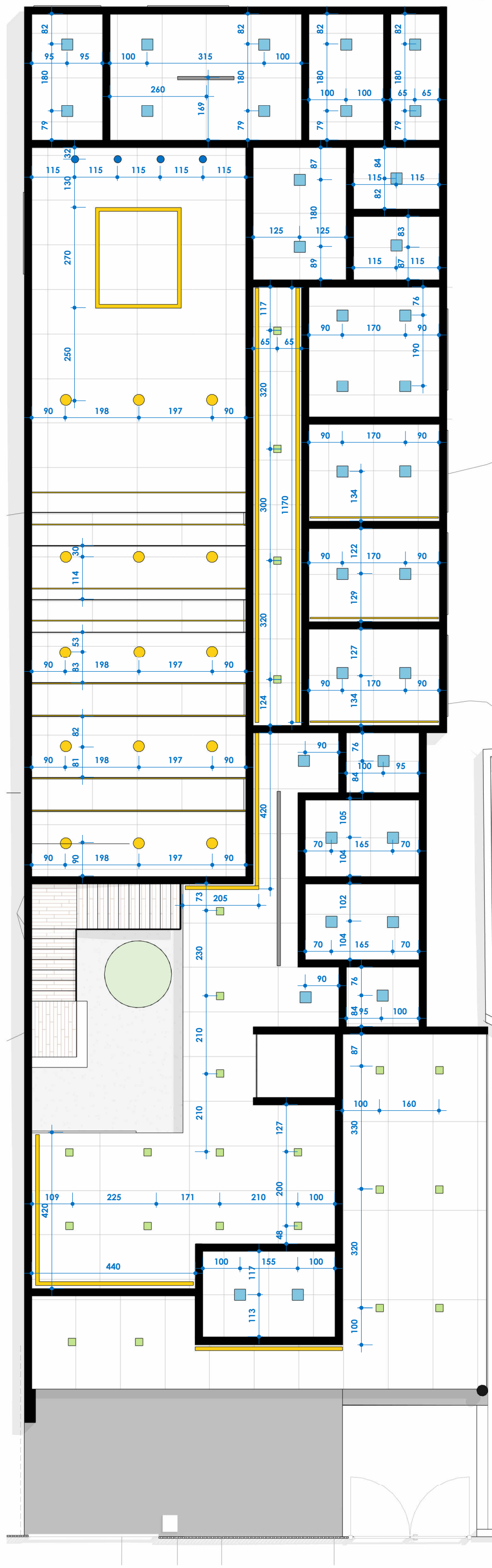
PLANTA LUMINOTÉCNICO TÉRREO ESC: 1 : 100
