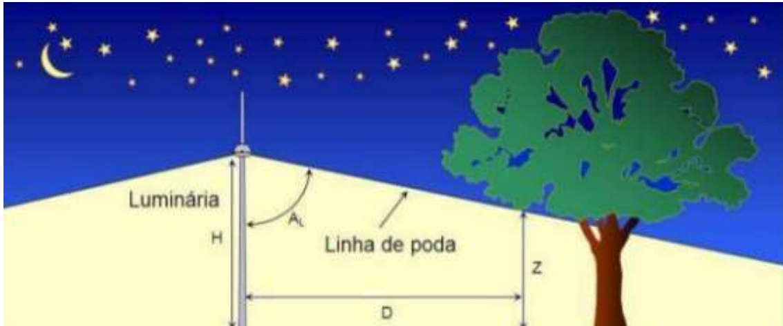
Projeção da desobstrução longitudinal - fonte: ND-3.4 Cemig
