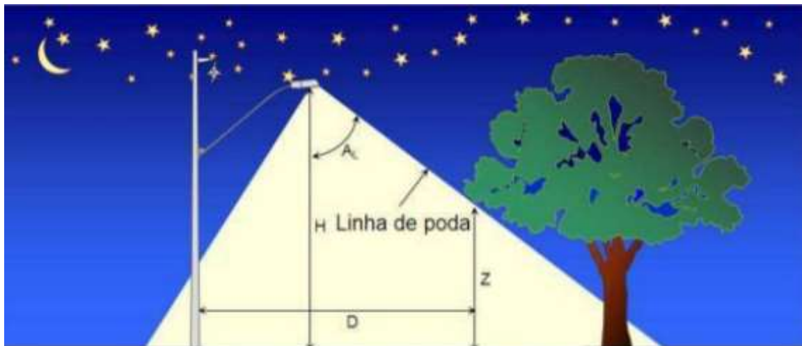
Projeção da desobstrução lateral - fonte: ND-3.4 Cemig
